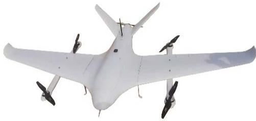
Рис. 1. БПЛА самолетного типа с ВВП.
