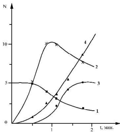
Рис. 1. Кинетические кривые расходования  $C_2H_5CHO$  (1) и накопления пероксидных радикалов (2),  $RCO_3H$  (3),  $RO_2H$  (4) при  $T=291^\circ C$  в реакторе, обработанном борной кислотой.  $[C_2H_5CHO] = N \times 10^{17}$ , [радикал] =  $N \times 10^{12}$ ,  $[RCO_3H]$  и  $[RO_2H] = N \times 10^{16}$  част.см $^{-3}$ .
